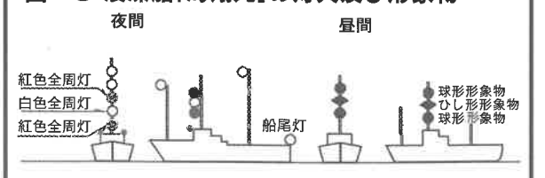
図-8 浅瀬船「海翔丸」の灯火及び形象物
