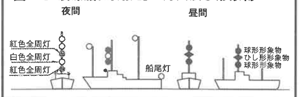
図-8 浚渫船「海翔丸」の灯火及び形象物
